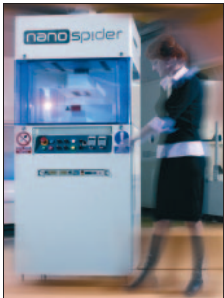
NS lab, laboratorní zařízení určené pro výzkum a vývoj nových nanovláknenných materiálů
