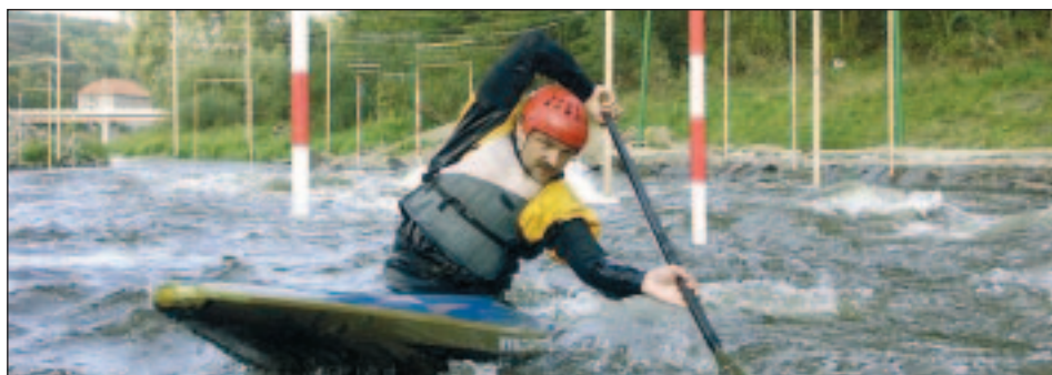
Závodní kánoe C-1 vyrobená z kompozitní hybridní tkaniny aramid-bazalt
