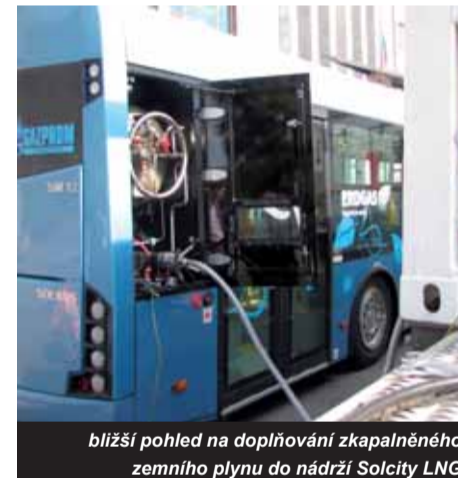
...doplňování LNG paliva do Solcity LNG bylo také obsahem praktické ukázky pro účastníky kulatého stolu v průběhu jedné z přestávek
