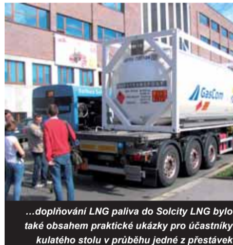
...doplňoval také nádrže autobusu Solcity LNG polského výrobce Solbus, které jsou umístěny v podvozkové části a nezvyšují tak výšku autobusu...
