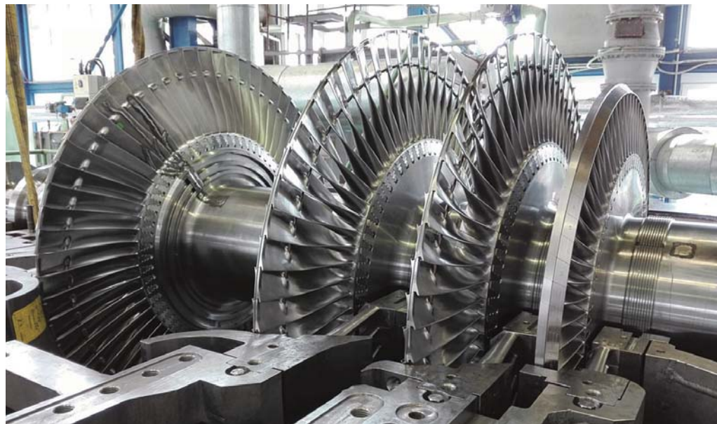
Zkušební turbína 10 MW s novým typem lopatkování (Doosan Škoda Power)
