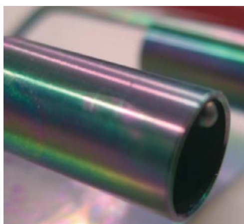
Palivový článek pokrytý diamantovou vrstvou
