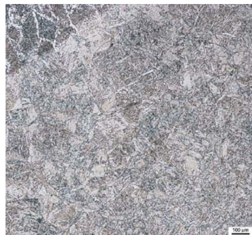
Obr. 1: bainitická struktura zušlechťeného odlitku. Vlevo nahoře feriticko-perlitická struktura po svařování
